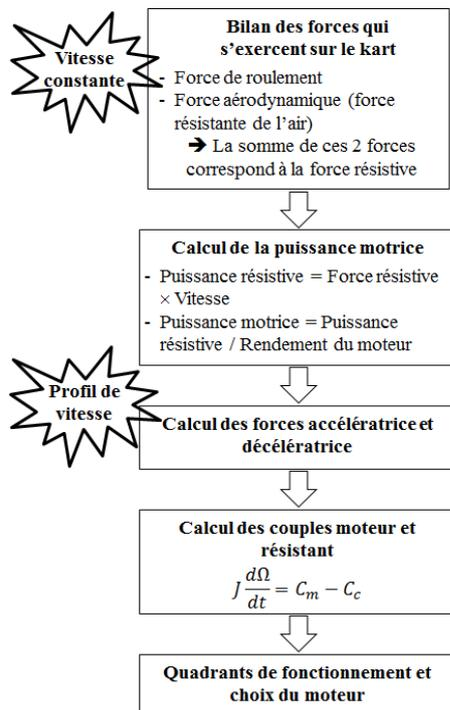
Fig. 1 : Étapes de dimensionnement du moteur électrique
