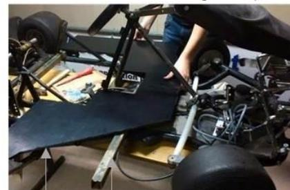
Élargissement et renforcement du châssis
